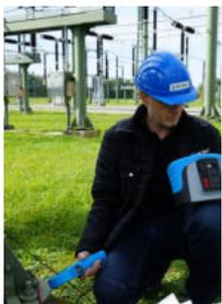
Flex- oder Eisenklemmen messen den selektiven Strom von der Einspeisung bis zum Gitter.
