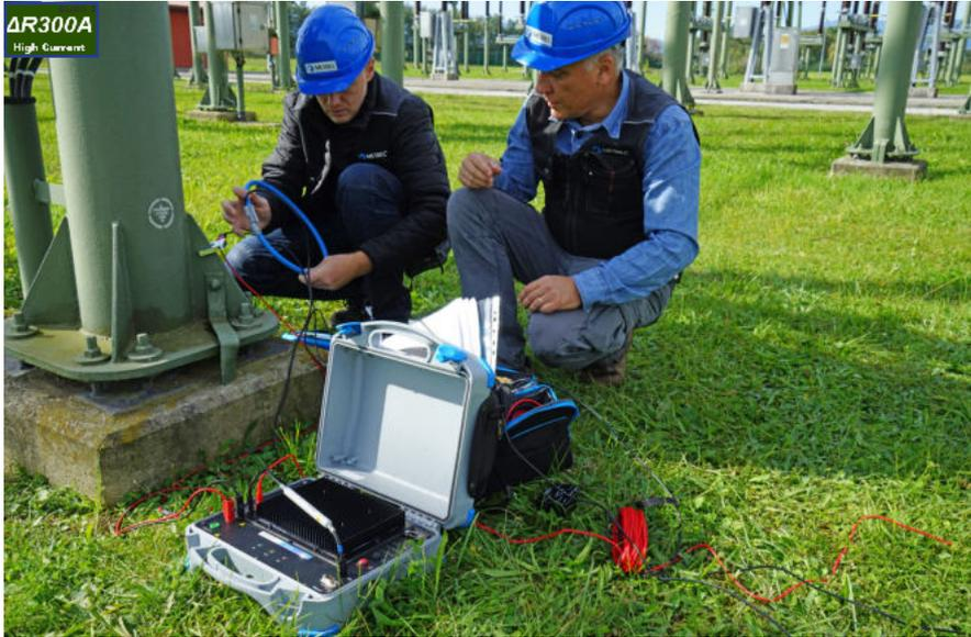
Der Erdungsintegritätstest sollte aus Sicherheitsgründen und zur Qualitätskontrolle vor allen anderen Tests für große Erdungssysteme wie Kraftwerke, Umspannwerke, Schaltanlagen, Eisenbahnen oder andere industrielle Anlagen durchgeführt werden.
