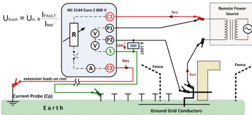
Erdpotentiale, Schritt- und Berührungsspannungen sind auf die Norm IEEE-81.2012 Teil 9 zu beziehen. Die Messwerte sind mit den angegebenen Körperwiderstandswerten zu vergleichen.
