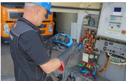
GPU-Qualität und -Sicherheit können mit dem Einsatz von MI 3155 EurotestXD vollständig ausgewertet werden, wenn IT-Schutzschaltungen und Isolierungen geprüft werden sollen.
