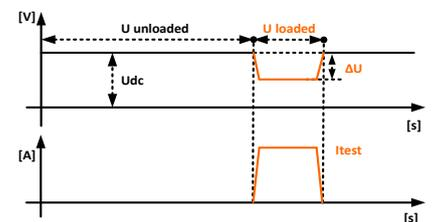
Prüfung des Schleifenwiderstands des DC 28 V Erdungsnetzteils unter Spannung. Die Hi-Power-Last ist während der Testphase mit dem GPU-Kreis verbunden. Der gemessene Spannungsabfall und Laststrom liefern das Ergebnis einer möglichen Fehlkontakt- und Kurzschlussstromberechnung, um einen geeigneten Sicherungsschutz zu ermitteln.
