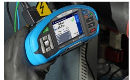
Impedanz mit einer Auflösung von 1mOhm detaillierte Auswertung des  $I_{sc\ min}$ ,  $I_{sc\ max}$  und Z HOT des Transformators basierend auf der Überhitzungsreserve.
