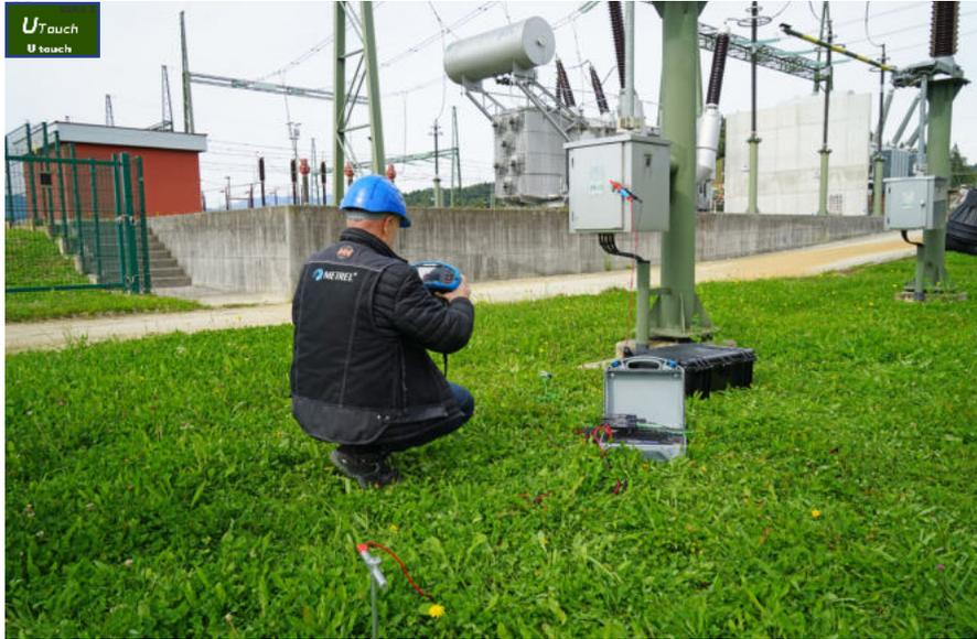
Die tatsächliche Größe der Schritt-, Berührungs- und Übertragungsspannungen kann dann durch Skalierung der Messwerte auf den zukünftigen Fehlerstrom bestimmt werden. Dieser Strom kann während eines Erdungsfehlers oder eines Blitzschlags auftreten.
