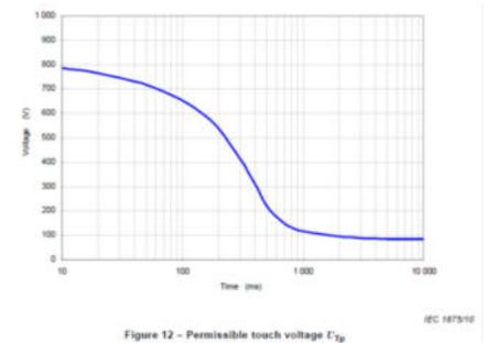
Beispiel für den zulässigen Körperstrom  $I_B$  und berechnete Werte der zulässigen Berührungsspannung  $U_{Tp}$  in Abhängigkeit von der Fehlerdauer  $t_f$
