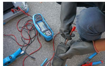
Das Belasten von Stromkreisen mit einem 90 kVA-Generator und das Testen mit der 4-Leiter-Kelvin-Methode führt zu stabilen Ergebnissen von 50 mΩ und 2,2 kA prospektiver Kurzschlussfähigkeit, die für alle drei Phasen im Falle einer fehlerfreien GPU gleich sind.
