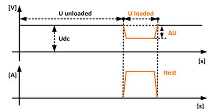
Prüfung der Schleifenbeständigkeit von DC-Netzwerken und Gleichstromquellen unter Spannung für ein breites Anwendungsspektrum. Die Qualität der Batteriebänke und der einzelnen Zellen kann ausgewertet und in Prozent des Spannungsabfalls beim Laden gemessen werden. Die Zellen werden miteinander verglichen, um mögliche Stromausfälle zu vermeiden.
