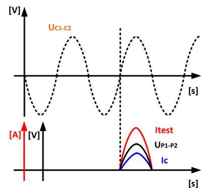
Die Messung erfolgt innerhalb einer Halbwelle und somit sind die Sicherheitsbedingungen auch bei Hochstromimpulsen mit bis zu mehreren hundert Volt erfüllt. Synchronisiertes Messverfahren und eine höhere Stromamplitude verbessern die Unempfindlichkeit gegen Spannungsrauschen.
