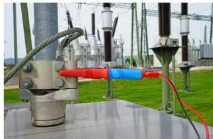
Kelvin-Klemmen gewährleisten eine solide 4-Draht-Verbindung für zuverlässige Ergebnisse.
