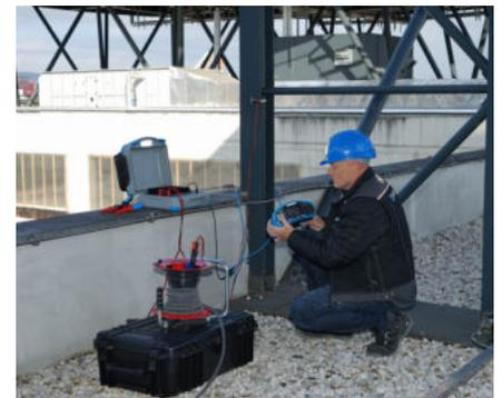
Körperwiderstands-Simulation mit 1 kΩ Adapter A1597 zur korrekten Berechnung der Berührungsspannung.
