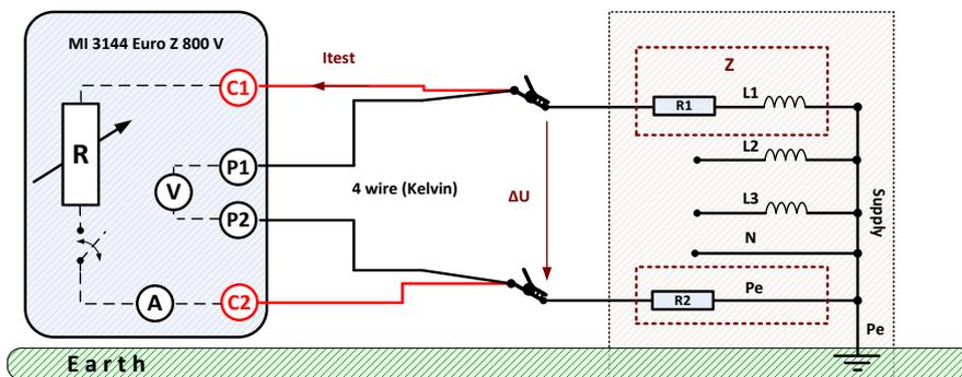
**Fehlerschleifen-Impedanzprüfung** unter Spannung mit einem Prüfstrom von 300 A in CAT IV-Umgebung mit Spannungen bis 440 V (MI 3143) / 800 V (MI 3144) und Frequenzen im Bereich 16 bis 420 Hz.
