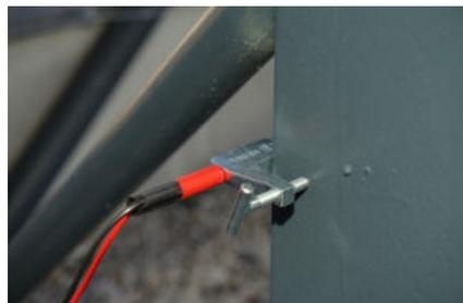
Eine solide G-Klemme verbindet die Messleitungen durch lackierte oder verrostete Oberflächen, um den Hochstrom auf geerdete Leitungen zu führen.
