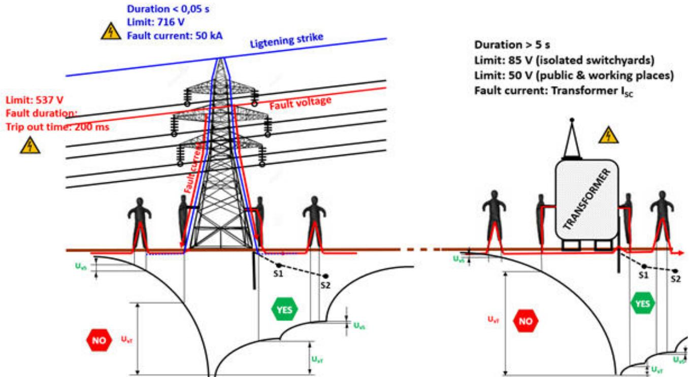
Die Berechnung der Berührungsspannung auf dem Gerätebildschirm kann aus der Liste der Parameter ausgewählt werden. Der Fehlerstrom in der Gleichung ist ein manuell eingestellter Wert der vorhergesagten Leistung eines Blitzeinschlags, z.B. 50 kA. In Kombination mit dem Körpersimulator A 1597 wird die Messung dem Gefährdungspotenzial von Blitzschutzanlagen angepasst.
