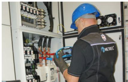
Automatische Auswertung der Auslösefähigkeit mit hoher Genauigkeit und Ergebnisstabilität auch bei leistungsstarken Systemen mit Sicherungen über 1000 A, bei denen klassische Methoden nicht anwendbar sind.
