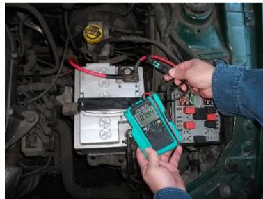
*Messung des DC-Stroms einer 12V-Autobatterie*
