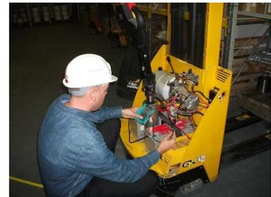
*Bei der Wartung eines Gabelstaplers kann der DC-Strom gemessen werden*
