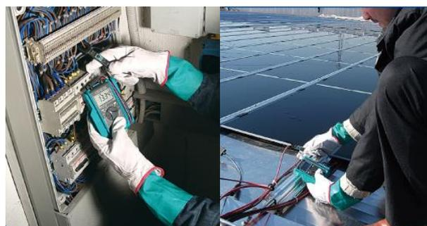
*Zuverlässige Messung auch bei verzerrtem Strom – der KEWMATE 2012RA im Einsatz an PV-Anlagen*
