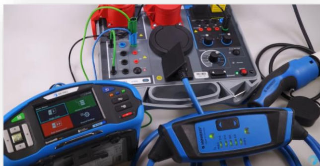
EVSE Mode 2 Geräte Test
