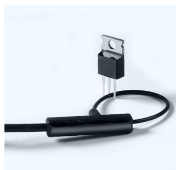
Spule an den Beinchen des TO-220
