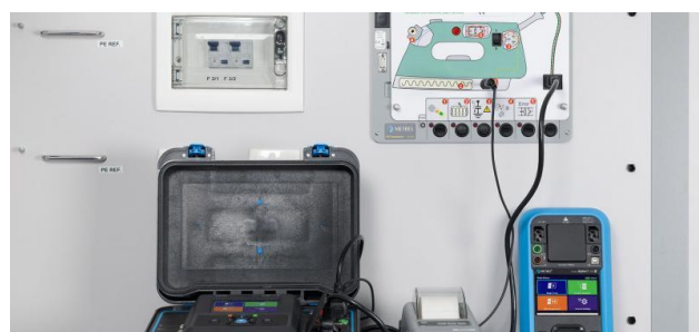
Prüfung von ortsveränderlichen Prüflingen SK I, SK II mit Fehlern
