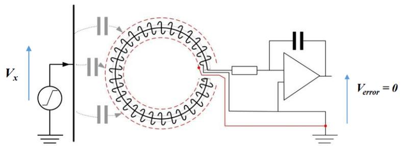
Vorteil: Abschirmung gegen hochfrequente Störspannungen  $dv_x/dt$
