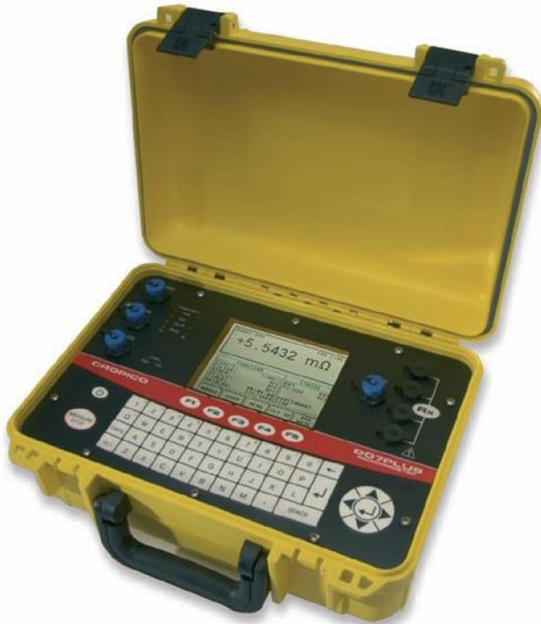
Der DO7 Plus ist ein 10A-Mikroohmmeter, der sich für Anwendungen in der Luft- und Raumfahrt, der Energie- und Wasserversorgung, der Kabel- und Maschinenbauindustrie sowie generell in allen Betrieben eignet, in denen eine Abkühlkurve zur Darstellung von Widerstandsspitzen ermittelt werden muss. Das Gerät wird in einem versiegelten IP67-Behälter (geschlossen oder IP53 mit geöffnetem Deckel) geliefert und ist robust zur Gewährleistung langer Standzeiten ausgeführt.
