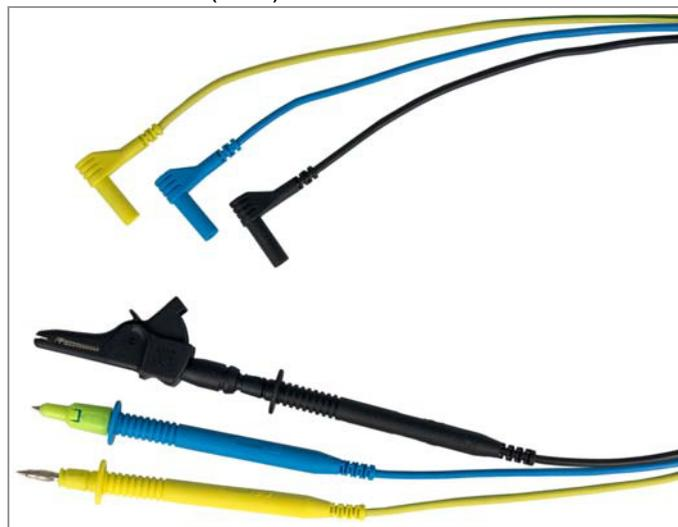
Messleitungen (schwarz, blau, gelb-grün) mit Prüfspitze und Sicherheitskappen (CAT IV 300 V, CAT III 600 V) sowie Krokodilklammern CAT III 1000 V.
