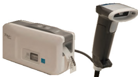
1001-046 Barcode-Etikettendrucker (USB) Ausdruck von Prüfetiketten mit Barcode und Gut/Schlecht- Kennzeichnung
