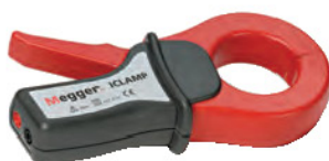
ICLAMP Strom-Messzange (Öffnung 54 mm). Zur Messung von Leck- und Ableitströmen bis max. 200A, sowie als Messzange zur selektiven bzw. zur spißlosen Erdungsmessung
