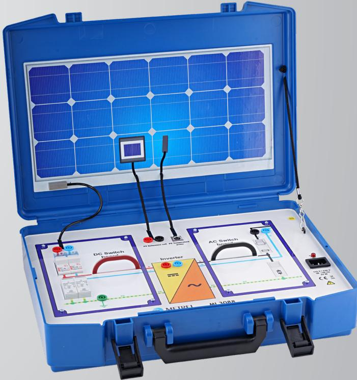
Das Demo-Board MI 3088 simuliert typische Photovoltaiksysteme mit einem PV-Modul und einem DC/AC-Wechselrichter. Es stellt eine typische Anlage bestehend aus PV-String, DC-Schaltbox, DC/AC-Wechselrichter und einem Einphasenanschluss an das Stromnetz. Es wird vornehmlich von Vertriebspersonal zur Demonstration der Messmethoden und -abläufe an der DC-Seite und teilweise auch an der AC-Seite eines PV-Systems verwendet.
