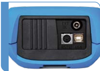
Kommunikation über USB- und RS232-Schnittstelle.
