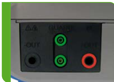
Das Anschlussfeld zum anschliessen der geschirmten Prüflleitungen
