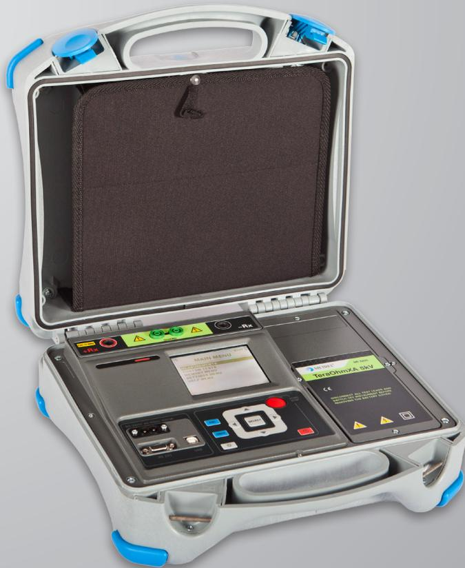
Das MI 3205 TeraOhm XA 5 kV ist ein tragbares, Batterie- (Li-Ion) oder Netzbetriebenes Prüfgerät mit ausgezeichneter IP-Schutzart (IP65 Gehäuse geschlossen und IP54 Gehäuse offen), zur Bestimmung des Isolationswiderstands, durch Verwendung von Hoch-Prüfspannungen bis 5 kV. Es wurde entwickelt und produziert mit dem umfangreichen Wissen und der Erfahrung die über viele Jahre durch die Arbeit in diesem Bereich erworben wurde.
