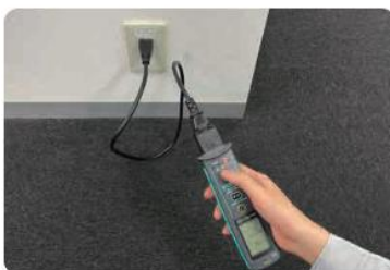
Einfache Messung durch einfaches Einstecken in eine Steckdose und Drücken der Prüftaste.
